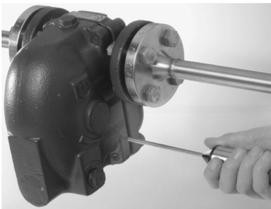
Bei Schwimmerkondensatableitern setzen Sie den Schallaufnehmer am Gehäuse waagrecht an.
