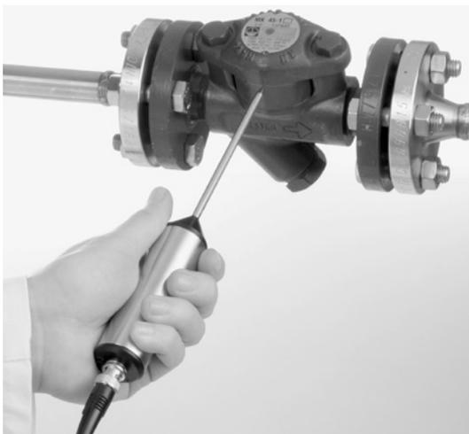
Bei Gestra-Kondensatableitern der **RHOMBUSline**-Baureihe setzen Sie die Spitze des Schallaufnehmers seitlich an das Ableitergehäuse.
