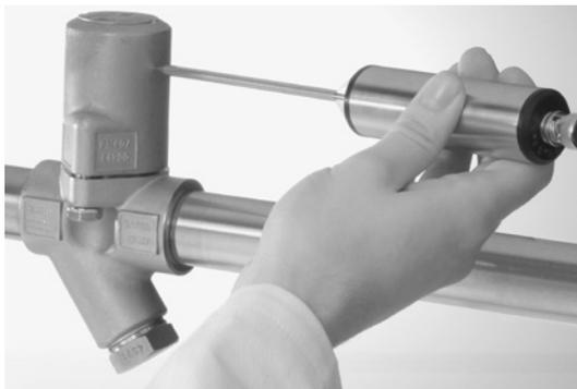
Bei konventionellen Ableitergehäusen setzen Sie den Schallaufnehmer waagrecht an den Deckel (Haube) des Kondensatableiters.
